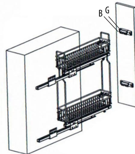
**5** Соедините крепления фасада с корзиной и отрегулируйте фасад, ослабив винт F и выровняв его винтами E. После регулировки затяните винт F
